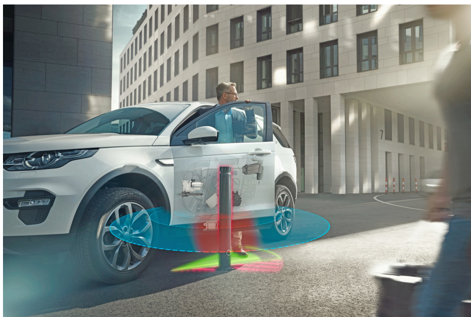
雷达传感器可为终端用户提供可靠的车门防碰撞保护
